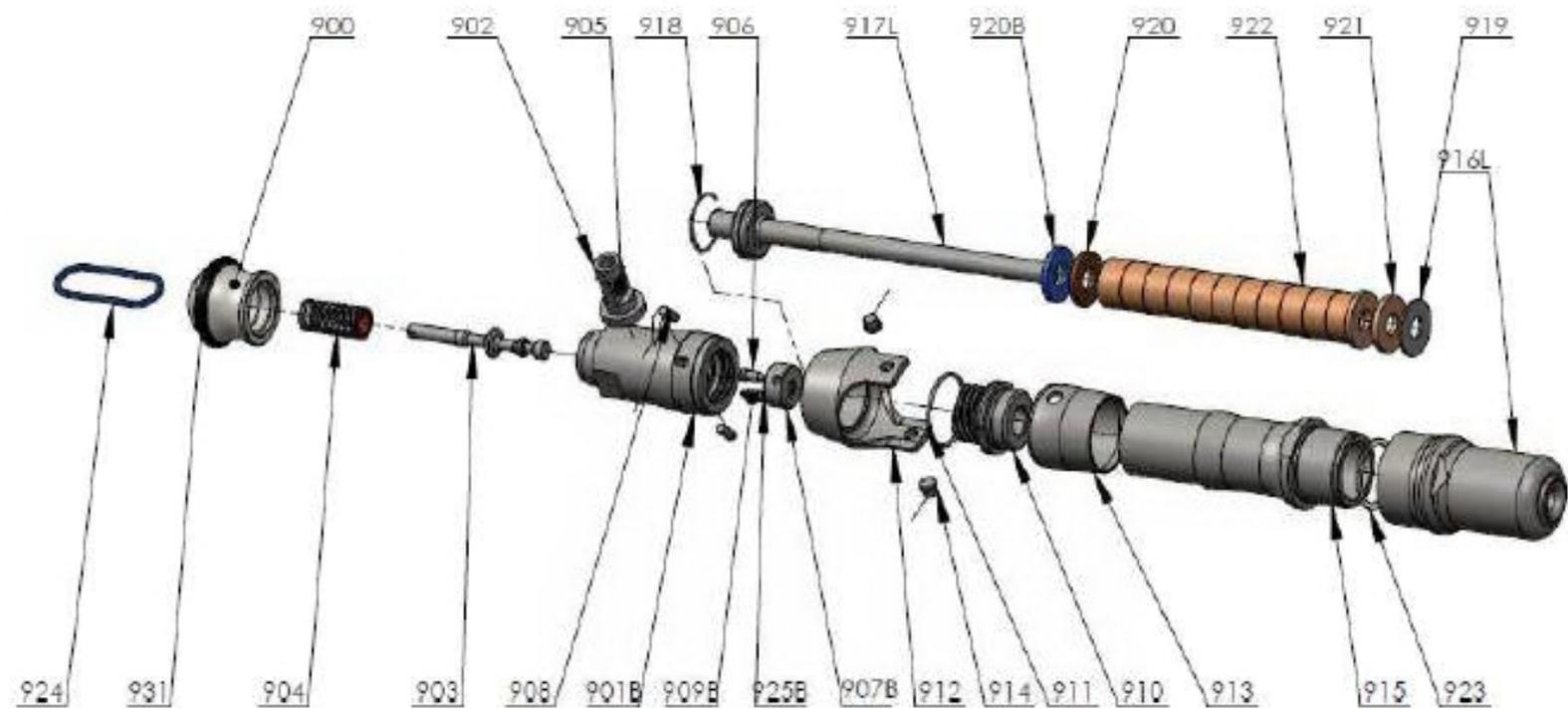
N.B. : Les pièces 910 et 915 sont dorénavant indémontables et doivent être changées simultanément
