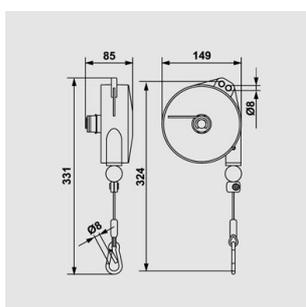
L'équilibreur est équipé avec un dispositif qui bloque la course par moyen d'une simple manoeuvre sur la charge.
