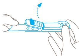
Tenez la lame du côté **non affûté** et utilisez-la pour soulever le cache-lame. Le cache reste en position ouverte.
