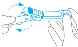
Retirez et retournez (pour gauchers) ou changez la lame. Veillez à bien réinstaller la lame en la plaçant **exactement sur l'ergot**.
