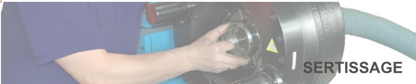
Le sertissage permet de fiabiliser le montage du raccord, lui assurant une tenue de grande qualité.
